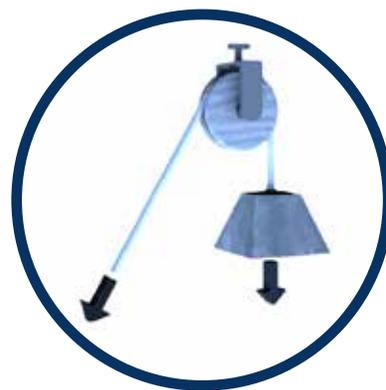
Ce système de poulie change la direction d'une force. Pour soulever le poids, il faut tirer vers le bas.
